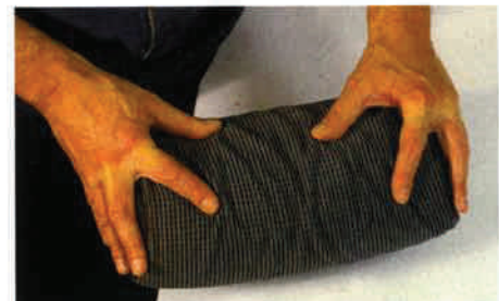
...Materialverhalten zu bedenken. Lederbezüge müssen meist etwas kleiner sein, um auf dem selben Polsterkern so stramm zu sitzen wie Stoff
