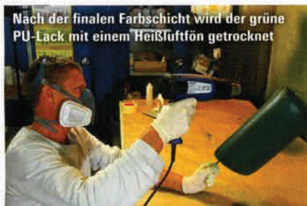
Insgesamt 14 Primärfarben auf Polyurethan-Basis stehen zur Verfügung. Über das richtige Mischungsverhältnis entscheidet das Auge und...
