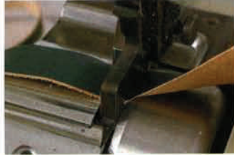
Das Leder, aus dem die Keder entstehen, wird auf einer speziellen Ausschärmaschine dünn geschnitten
