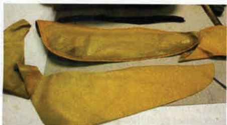
Nachdem Hagen Kruse die alte Sitzwanne aus dem Bezug herausgelöst hat, dient sie als Schablone. Vorne das bereits zugeschnittene...
