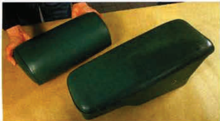
Der Vergleich der neu bezogenen Kopfstütze mit der gereinigten Stelle auf dem Farbmuster zeigt, dass der Farbton bereits sehr gut getroffen wurde
