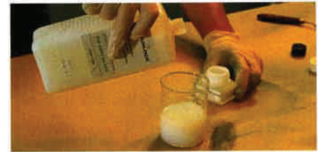
Abschließend wird ein Klarlack (auf englisch top coat ) vorbereitet. Ihn gibt es in verschiedenen Glanzgraden von matt bis hochglänzend
