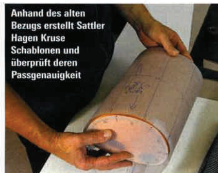
Die Sattlerarbeit beginnt mit dem Zerlegen des zu beziehenden Teils. Der Bezug der Kopfstütze wird...
