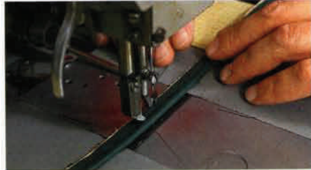
Eine lange, gerade Naht: Bevor der Keder um das Seitenteil herum befestigt wird, wird zunächst die Seele eingenäht
