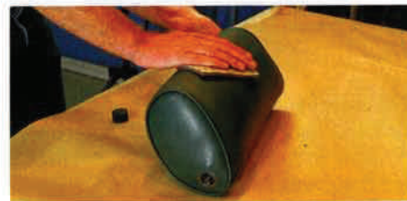
Ist die Farbe trocken, wird die Oberfläche mit einem extrem feinen Schleifpad bearbeitet; so werden Stellen, die etwas zu rau sind, geglättet
