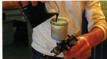
...eine gehörige Portion Erfahrung. Die marginal korrigierte Farbe wird anschließend in eine Lackierpistole gefüllt, und dann ganz dünn...
