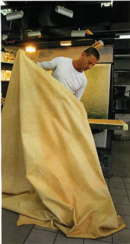
Materialprobe: Zuerst überprüft Leder-Fachmann Tobias Hundeshagen die Beschaffenheit der Haut. Es handelt sich um pflanzlich gegerbtes Rindsleder
