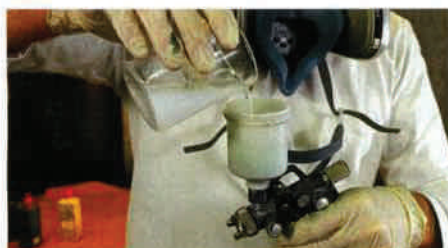
Der top coat wird genau wie zuvor die Farbschicht mit der Sprühpistole aufgetragen. Glanzgrad und Art des Auftrags richten sich nach der originalen...
