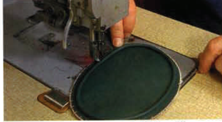
Dann werden die Keder und die Seitenteile miteinander vernäht. Hier gut zu erkennen: das helle Naturleder unter der grünen Farbschicht
