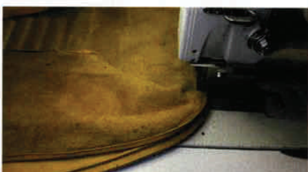
...neue Stück aus gebrauchtem Leder. Dann werden der alte Bezug, die neue Sitzwanne und der nachgefertigte Keder miteinander vernäht
