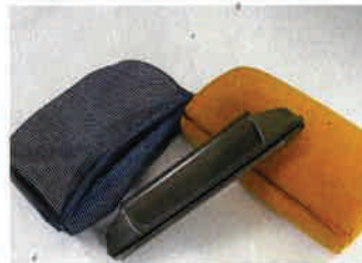
...danach über den Schaumstoff abgezogen. Der Metallkern verleiht der Kopfstütze Stabilität
