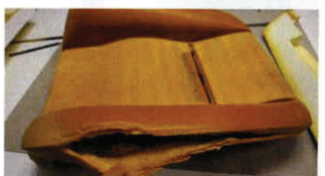
Nicht nur der Lederbezug, auch der Schaumstoff darunter hat in den letzten 30 Jahren gelitten. Die Lehne ist dringend reparaturbedürftig
