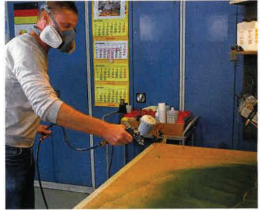
Lack auf Leder: Auch der Farbauftrag ähnelt einer Autolackierung: Die Farbe auf Polyurethan-Basis wird mit einer Sprühpistole auf das Leder lackiert
