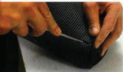
Die Sattlerarbeit beginnt mit dem Zerlegen des zu beziehenden Teils. Der Bezug der Kopfstütze wird...
