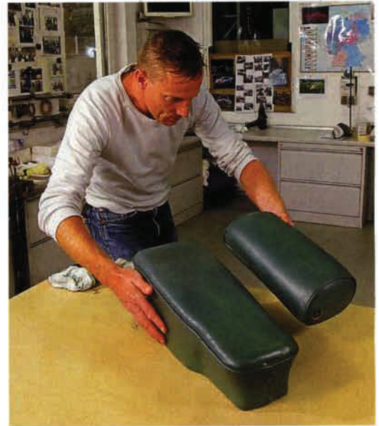
Nach der Reinigung vergleicht der Lederexperte noch einmal die Vorlage mit der Kopfstütze und entscheidet dann über etwaige Farbkorrekturen
